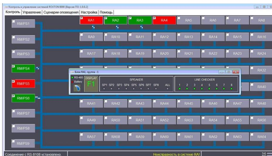
Рис.5.4. Окно состояния исполнительного блока.
