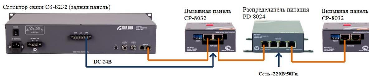
Рис.4.2. Организация питания абонентских панелей системы селекторной связи ROXTON 8000.
