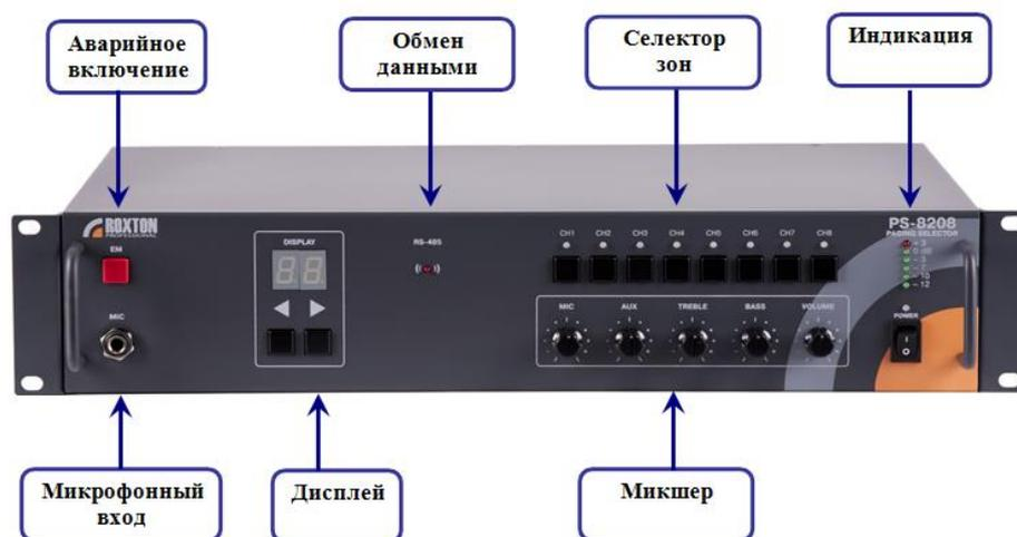
Рис.3.6. Состав блока контроля и управления PS-8208.
